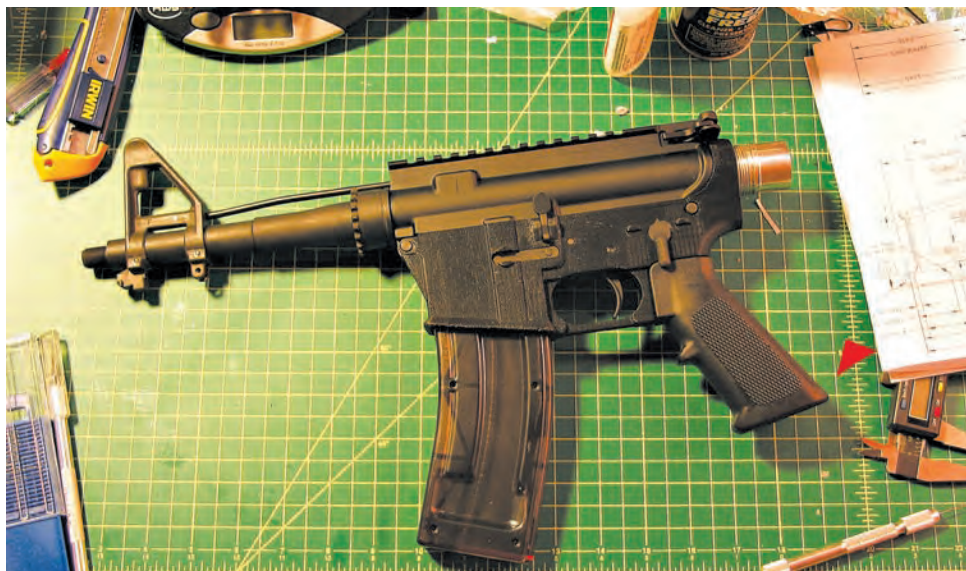
Un arma defensiva con receptor inferior de plástico, producida con impresora 3D, que construye un objeto capa por capa. Se cuestiona efectividad del material usado.
